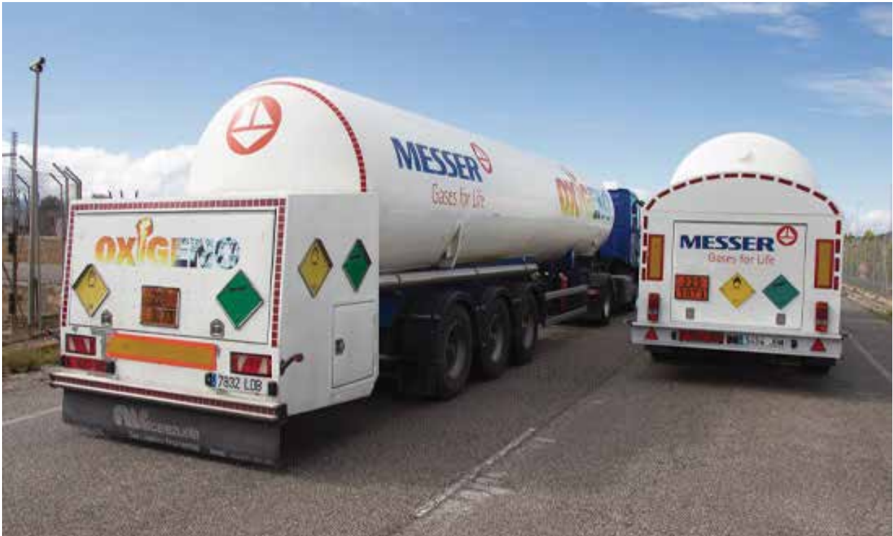
Vista trasera de camiones cisterna criogénicas aislados con sector de válvulas e instrumentos
