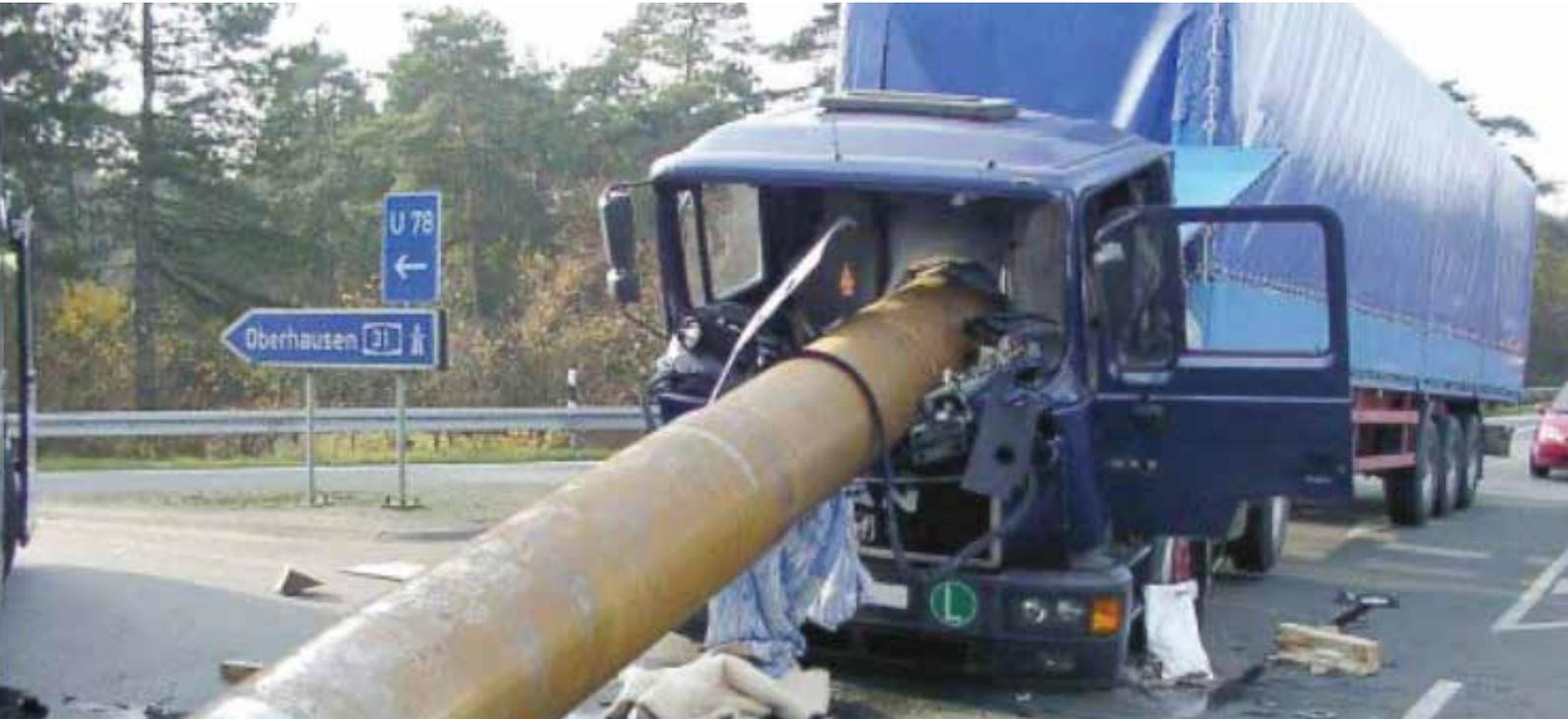
**Debido a una frenada brusca, unos tubos de acero incorrectamente amarrados atravesaron la compuerta delantera y la compuerta del conductor.**
