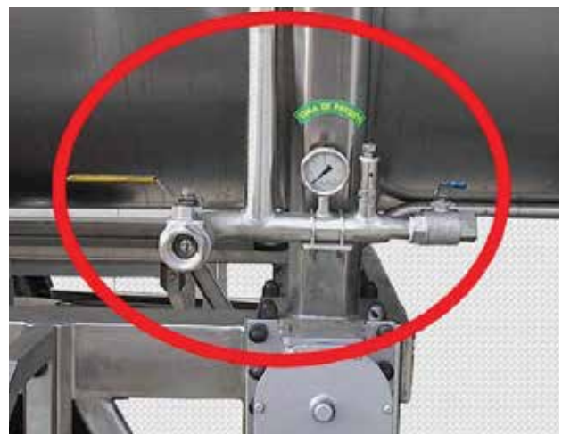
CIRCUITO DE ENTRADA DE AIRE
