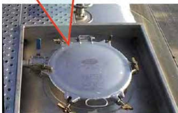
Tapa cisterna químicos diversos formaldehído, sosa, ácido acético,...
